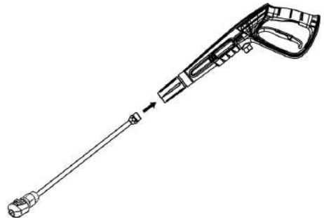
Рис. 3 Установка головки и струйной трубки
