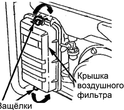
Рис. 14 Снятие крышки воздушного фильтра
