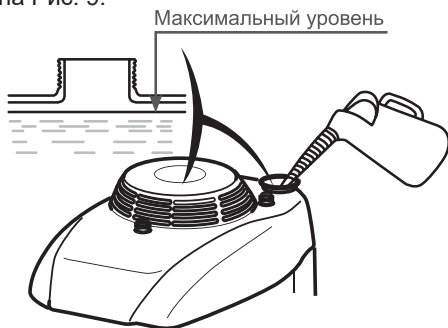
Рис. 9. Максимальный уровень топлива в топливном баке
