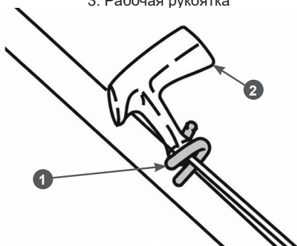
Рис. 6. Крепление ручки стартера на рукоятке
