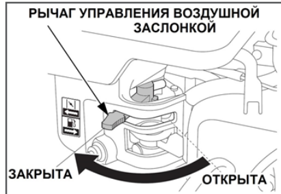
Рис. 14 Рычаг управления воздушной заслонкой
