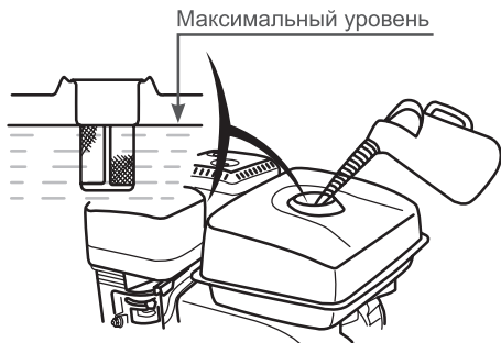
Рис. 9. Максимальный уровень топлива в топливном баке
