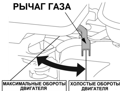
Рис. 20. Положения рычага газа
